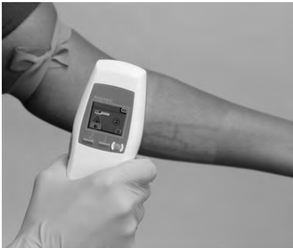
Slika 1: Naprava za iskanje perifernega ožilja z infrardečim valovanjem - AccuVein (AccuVein, 2016)
