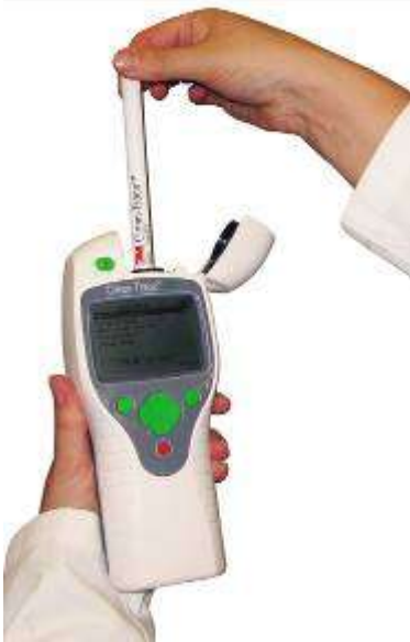
Slika 1: Vstavljanje aktiviranega ATP brisa v Luminometer
