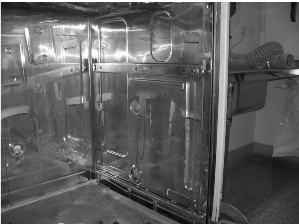
Slika 3. Primer namernega onesnaženja komore termodezinfektorja pri validaciji.
