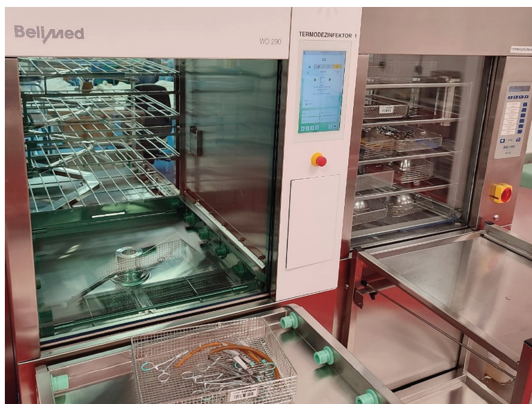
Slika 1: Polnjenje termodezinfektorja v nečistem prostoru (Vir: lasten)
