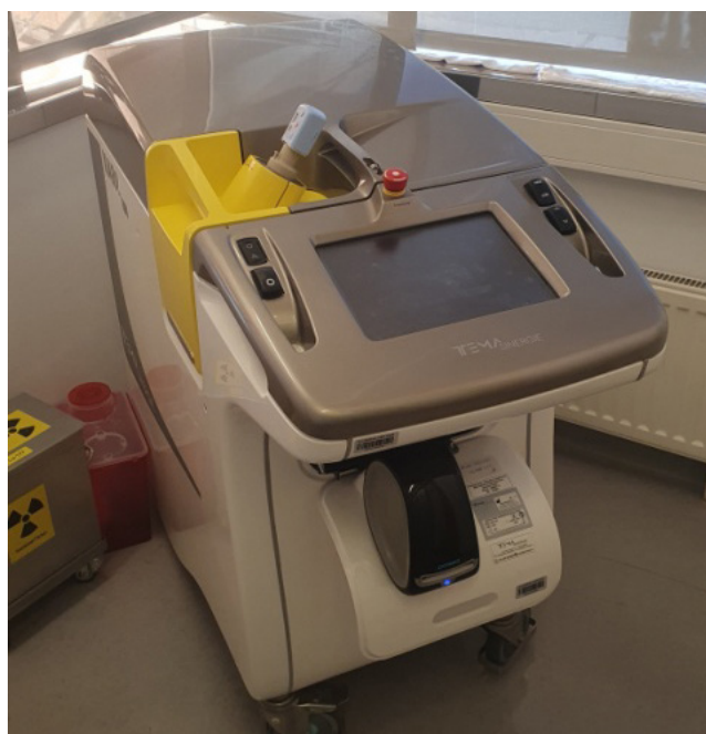
Slika 5: Razdeljevalnik za ^{68}\text{Ga} radiofarmake - Karl 100 (vir: osebni arhiv)
