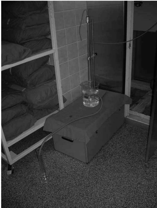
Slika3. Priprava za odvzem vzorca pare in analizo vsebnosti nekondenzirajočih plinov.
