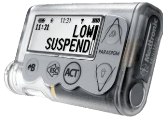
Slika 7: Inzulinska črpalka, ki opozarja in po potrebi samodejno ustavi dovajanje inzulina.
