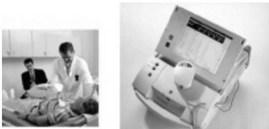
Slika 2. Programator, ki služi za komunikacijo s srčnim spodbujevalnikom.
