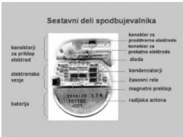
Slika 1. Sestavni deli spodbujevalnika
