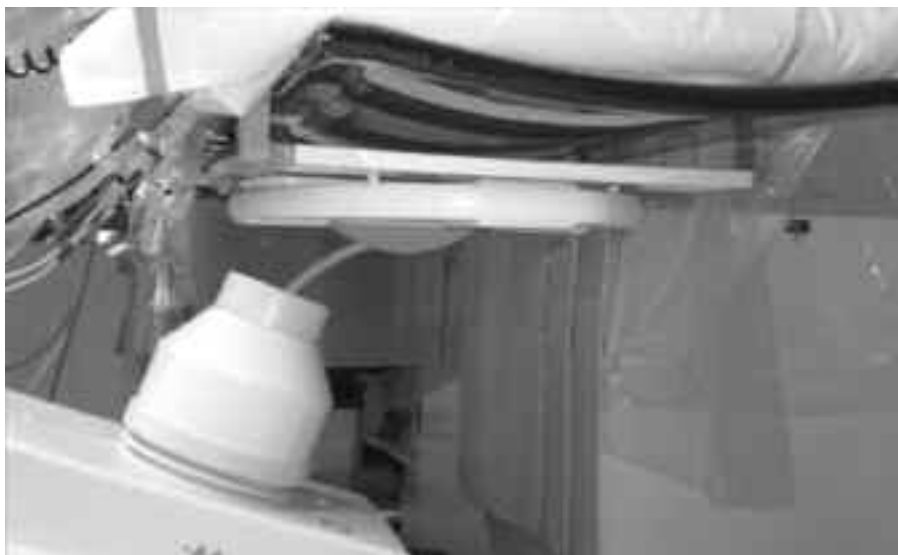
Slika 2: Trikotni okvir z magnetnimi tuljavami, nameščen pod preiskovalno mizo (Foto: Urbančič, 2013).
