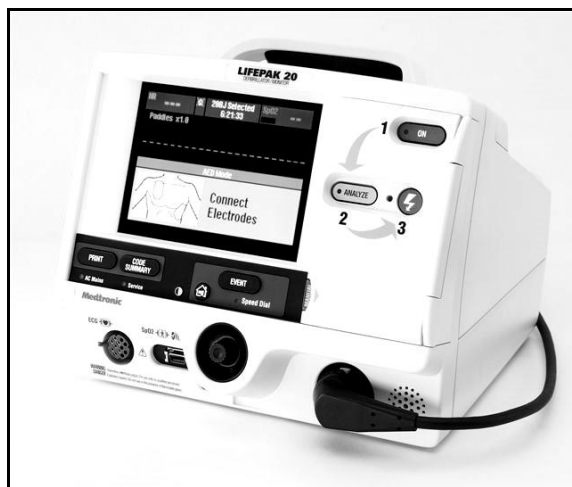
Slika 13: Uporaba klasičnega defibrilatorja v avtomatskem načinu.
